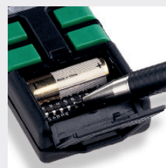
PROGRAMMIERBARE CODES MITTELS DIP-SCHALTER
